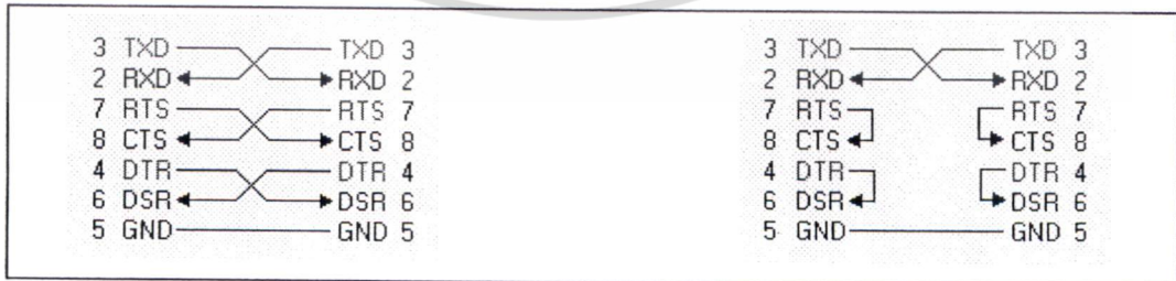
รูปที่ 2.15 การเชื่อมต่ออุปกรณ์ภายนอกผ่าน DB9 แบบ
