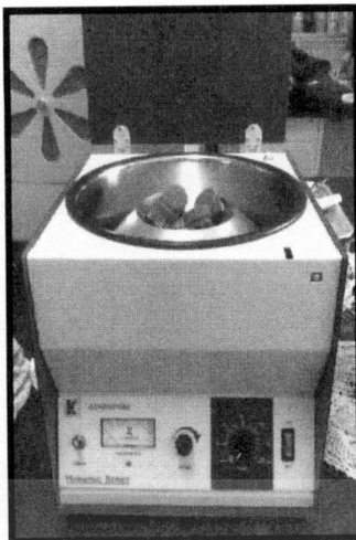
รูปที่ ก.3 เครื่องปั่นเหวี่ยงแยกสาร GEMMY รุ่น PLC - 012
