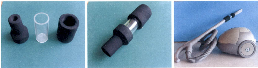
ภาพที่ 1. หลอดดักจับไรฝุ่น (KMITL mite trap) ติดกับเครื่องดูดฝุ่น
