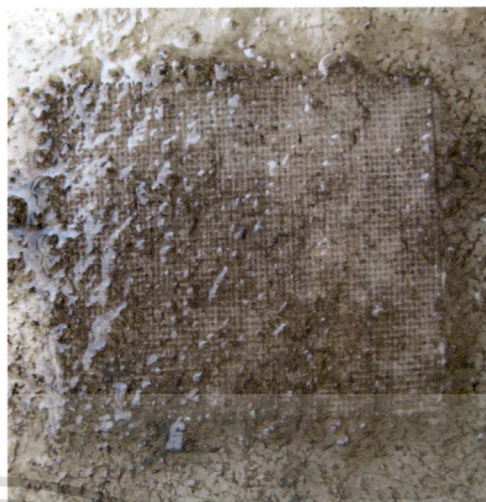
รูปที่ 4.6 การเกาะของเพรียงหินที่ความเข้มข้นของสารละลายที่ความเข้มข้น 20 ppm รูปที่ 4.7 การเกาะของเพรียงหินที่ความเข้มข้นของสารละลายที่ความเข้มข้น 30 ppm
