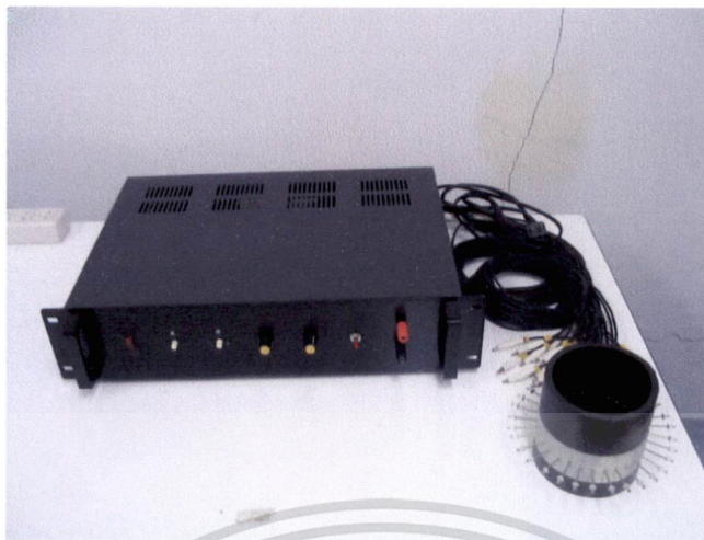
ภาพที่ 4.6 เครื่องเก็บข้อมูลแบบ 32 บิตเล็ก โทรอด
