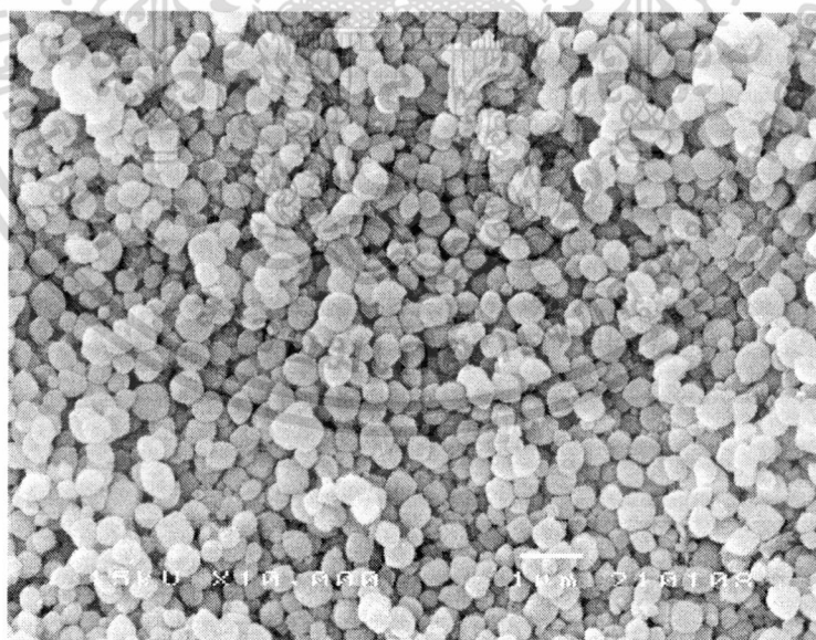
รูปที่ 4.7 SEM ของซีโอไลต์ที่สังเคราะห์จากซิลิกาที่สกัดจากเถ้าลอยของขานอ้อยที่เวลาการตกผลึก 48 ชั่วโมง ( \text{Si/Al} = 15.81 ) อุณหภูมิในการสังเคราะห์ 135 องศาเซลเซียส
