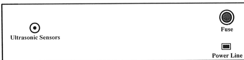
รูปที่ ก3 แสดงการวางเลย์เอาต์ที่ด้านหลังของต้นแบบระบบวัดปริมาณเนื้อยางแห้งในน้ำยางด้วยคลื่นอัลตราโซนิก
