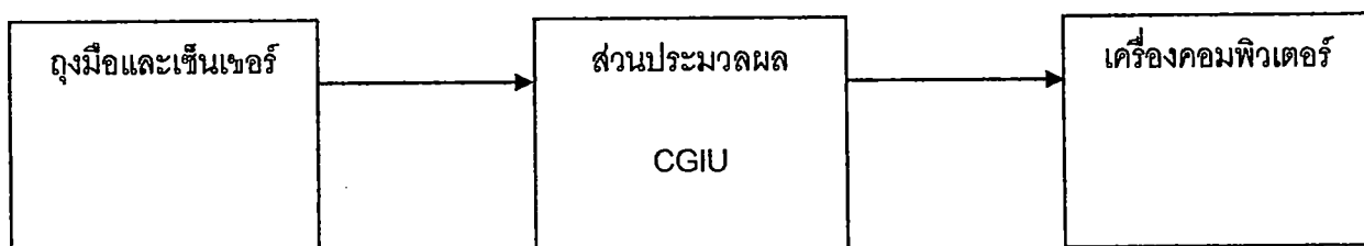
รูปที่ 2.2 การเชื่อมต่ออุปกรณ์ในชุดอุปกรณ์ถุงมืออิเล็กทรอนิกส์
