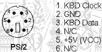
รูปที่ 6 หัวต่อของแป้นพิมพ์ แบบ 6 Pin Mini-DIN (PS/2)
