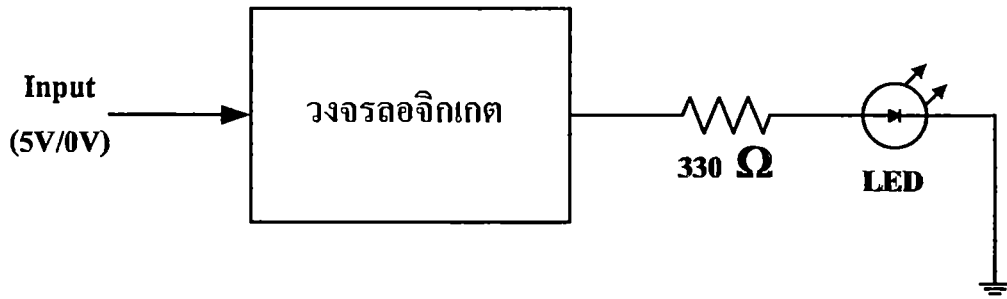
รูปที่ 1 แสดงการต่อวงจรลอจิกเกตเพื่อแสดงผลทาง LED
