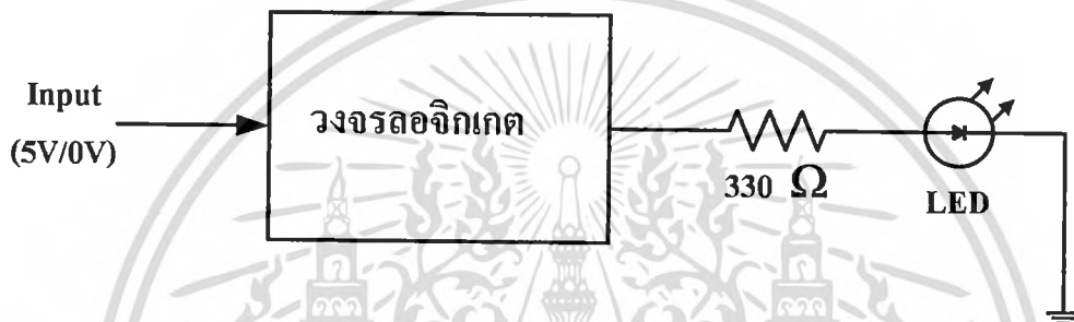
รูปที่ 1 แสดงการต่อวงจรถลอจิกเกิดเพื่อแสดงผลทาง LED
