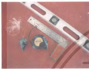
3 อุปกรณ์วัดขนาดฉาก และระดับน้ำ
