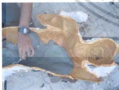
ภาพที่ 6 นำปูนที่ผสมไว้ดีแล้วมาพอกลงบนพิมพ์เน้นความหนาของปูนมีความเสมอกันโดยประมาณ 1 ซม. ให้มีความสำคัญกับทรายละเอียด
