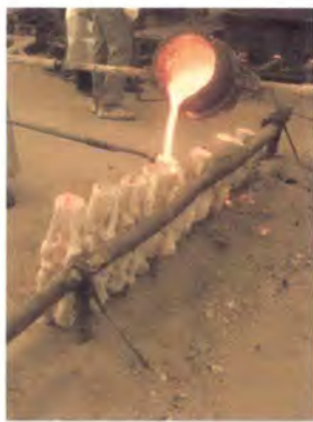
ภาพที่ 14 เมื่อแร่โลหะถูกหลอมสมบูรณ์ จึงนำมาเทลงบนพิมพ์เซรามิกเซลล์
