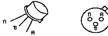
รูปที่ 5 ลักษณะสมบัติของทรานซิสเตอร์
