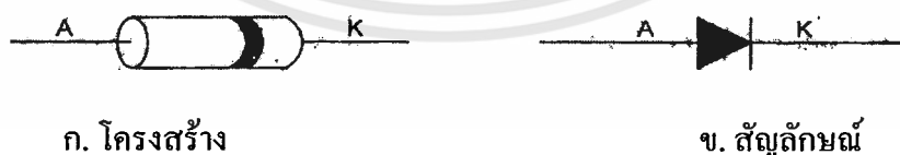
ภาพที่ 2.4 โครงสร้างและสัญลักษณ์ของซีเนอร์ไดโอด
