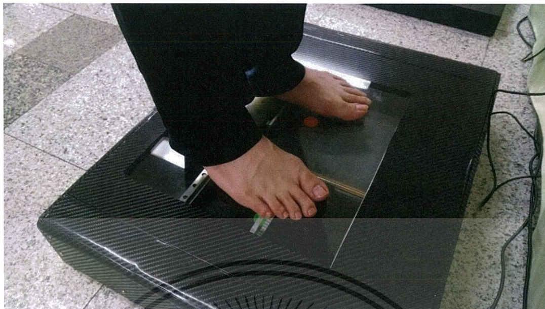
รูปที่ 3 เครื่อง Smart Digital Podoscope เริ่มสแกนเท้าข้างซ้าย
