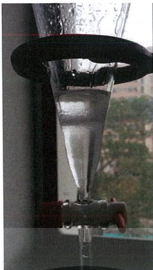
รูปที่ 3.2 การสกัดกรดฟอสฟอริกด้วยตัวทำละลายอินทรีย์
