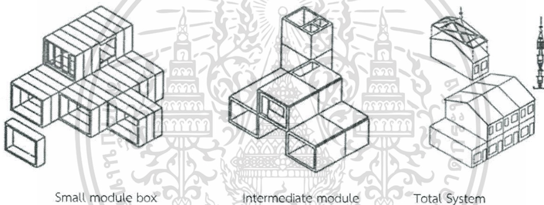
รูปที่ 2.9 ระบบโครงสร้างแบบกล่อง
