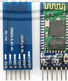
รูปที่ 3.3 HC-05 Bluetooth Module
