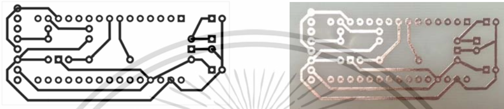
รูปที่ 3.7 วงจรที่ใช้ในการทำ PCB ในอุปกรณ์ตรวจจับ
